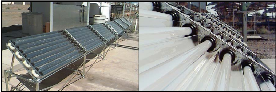
Figura 3.8. Fotografía de los dos fotorreactores CPC gemelos tomada en la PSA (izda.) y detalle de los tubos de un módulo de CPC durante un ensayo con \text{TiO}_2 en suspensión (dcha.).
